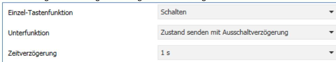
Abbildung 22: Einzel-Tastenfunktion Schalten - Zustand senden mit Ausschaltverzögerung
